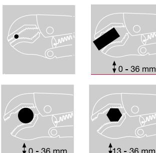
Zum Spannen und Halten von Profilen und Rohren durch Dreipunktauflage, ein doppeltes Prisma im Zangenmaul ermöglicht auch den Einsatz kleinstter Querschnitte. Zangenbacken aus Chrom-Vanadium-Stahl, geschmiedet.
