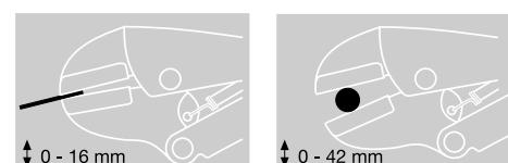
Zum Spannen und Halten von Werkstücken, Spezialverzahnung und Zangenmaulform ermöglichen das Spannen an der Maulspitze. Zangenbacken aus Chrom-Vanadium-Stahl geschmiedet.
